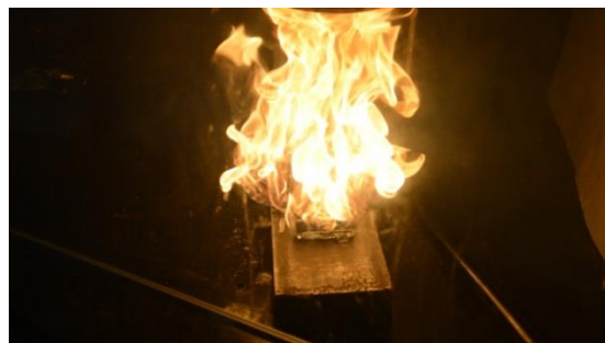
Рисунок 2. Свободное горение верхнего аккумулятора (21 с после произведения удара, температура поверхности аккумулятора - 500 °С)
