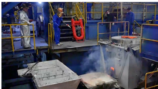
Рисунок 4. Окончание испытания - расплавленная медь покрыта быстротвердеющей пеной
