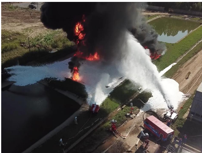
Рисунок 1. Тушение пожара в резервуаре площадью 1250 м 2 «гибридной пеной» модернизированными лафетными стволами УКТП «Пурга»
