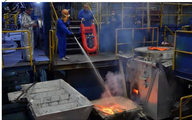
Рисунок 3. Подача быстротвердеющей пены на поверхность расплавленной меди
