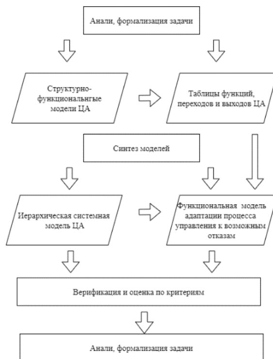
Рис.2 Алгоритм построения структурно-функциональной модели цифровых автоматов АИСОП
