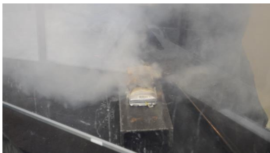
Рисунок 1. Начало активного задымления (8 с после произведения удара)
