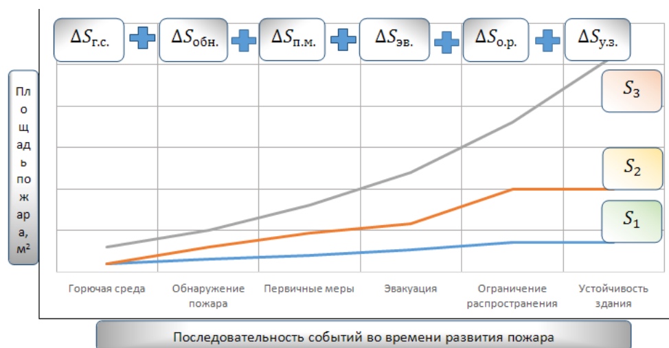
Рисунок 3 – Схема роста площади пожара: \Delta S – изменение площади пожара, определяемое характеристиками соответствующего блока концептуальной модели; S – возможная площадь пожара, к моменту прибытия пожарных подразделений
