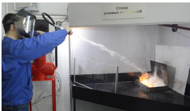
Рисунок 3. Подача быстротвердеющей пены (25 с с момента удара)
