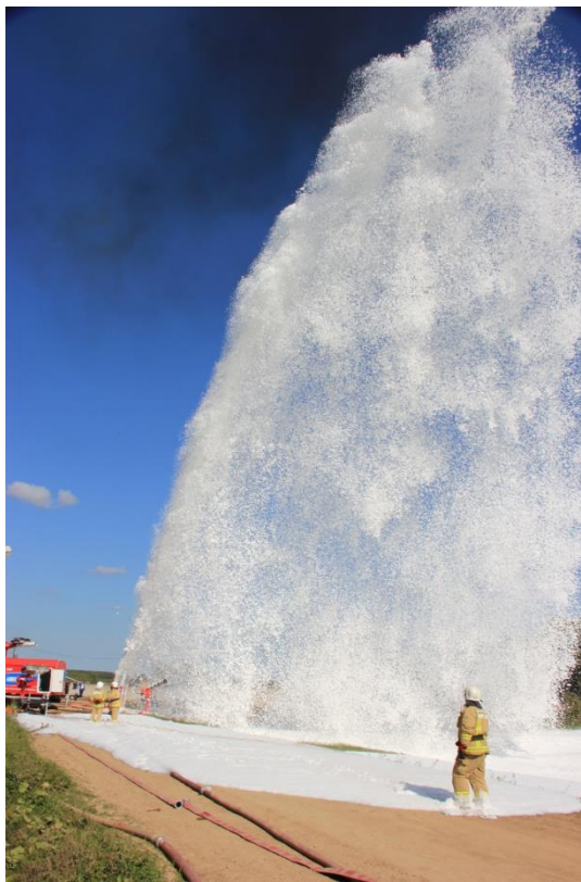
Рисунок 3. Подача «гибридной пены» установкой УКТП «Пурга-250»
