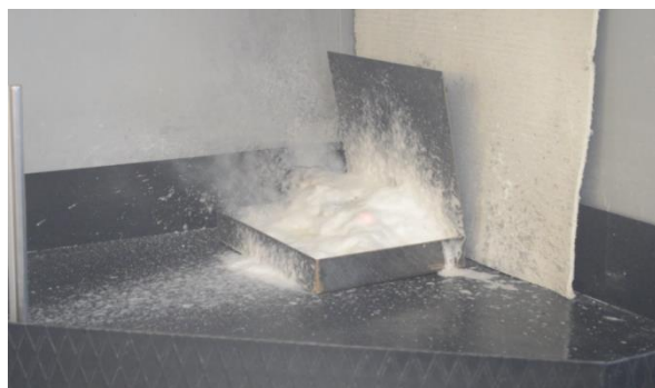
Рисунок 4. Результат тушения (температура поверхности пены на аккумуляторах через 1 мин - 26 °С)
