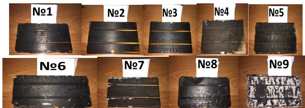
Рисунок 2. Образцы деревянных обрезных досок после эксперимента по сопротивляемости огню в помещении при температуре +15^{\circ}\text{C}
